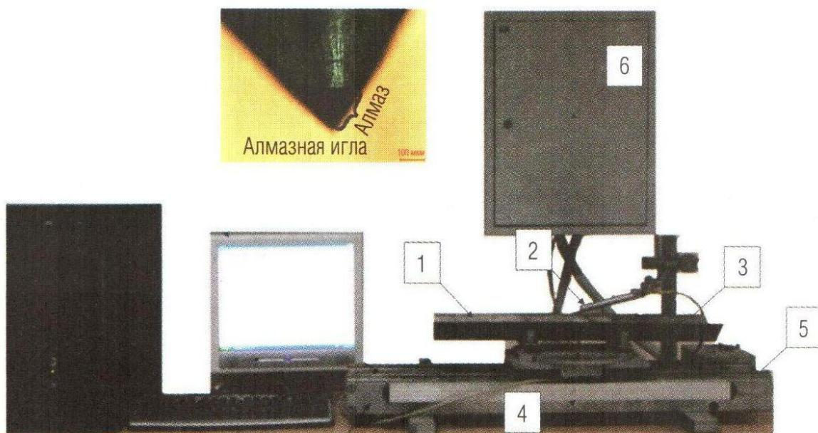
Рис. 1. Устройство профилографа:
