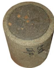
«Входной» образец с образовавшейся на его торце корки после прокачки через него бурового раствора
