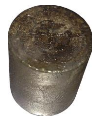
«Входной» образец после прокачки через него сначала бурового раствора, а затем кислотной композиции
