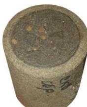
«Входной» образец с образовавшейся на его торце коркой после прокачки через него бурового раствора
