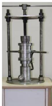
Кернодержатель для большеразмерных образцов
