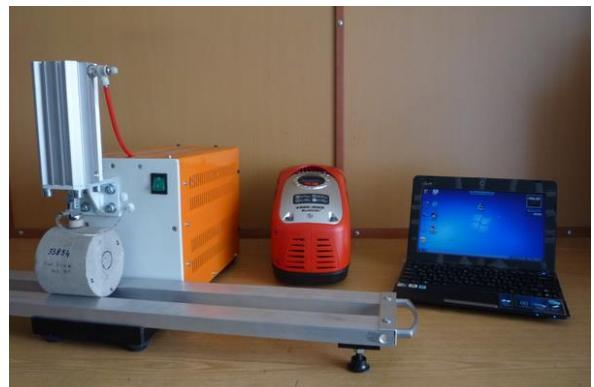
*Микропрофилирование используется при исследованиях неоднородных (тонкослоистых, трещиноватых и т.п.) пород. Этот метод позволяет в автоматическом режиме выделять тонкие прослойки (толщиной от нескольких микрон) сложенные различными литологическими типами пород (глинами, алевролитами, песчаниками), определять расчетным способом их пористость, остаточную водонасыщенность, а также оценивать линейные геологические запасы углеводородов, содержащихся в них.*
