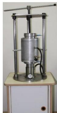
Кернодержатель для полноразмерных образцов
