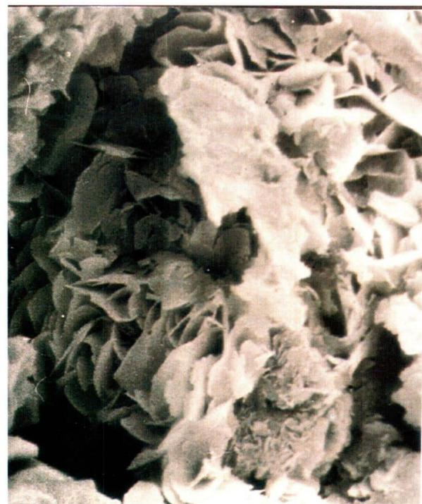
Рис. 6. Эпигенетический хлорит нескольких генераций, отличающихся размерами кристаллов (чешуек), в центре снимка присутствуют пленочный агрегат гидрослюды и ССО; снимок РЭМ, увеличено в 2 000 раз; Повховское месторождение, скважина 6047, пласт  $B_{B_8}$
