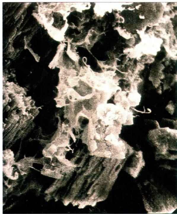
Рис. 8. Пленочно-волосовидные агрегаты эпигенетических гидрослюд и ССО, снимок РЭМ, увеличено в 2 000 раз; Повховское месторождение, скважина 83-Р, пласт ЮВ,
