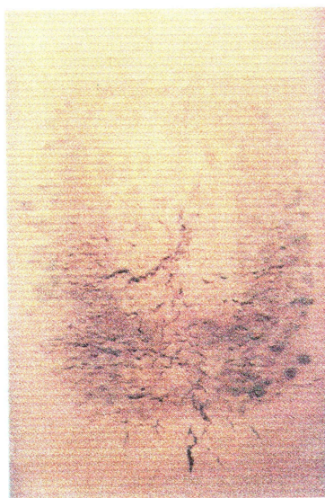
Рис. 2. Тектоноседиментационная модель по субмеридиональному сейсмопрофилю С 100 Восточно-Пальяновской площади до (а) и после (б) роста левого поднятия, зона трещиноватости, возникшая на поверхности модели над этим поднятием после его воздымания (в) и увеличенный фрагмент модели с левым поднятием (г).
