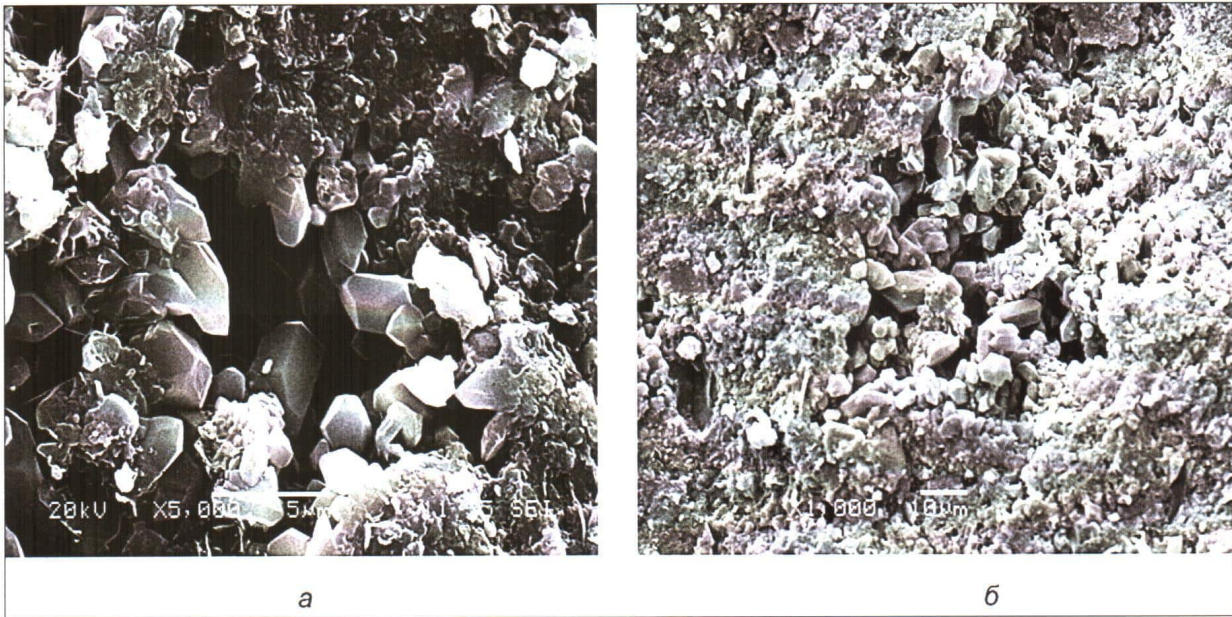
Рис. 6. Порово-микроаверновая емкость в силицитах баженовской свиты, подвергаясь воздействию гидротерм, Верхне-Салымское (а) и Приобское (б) месторождения
