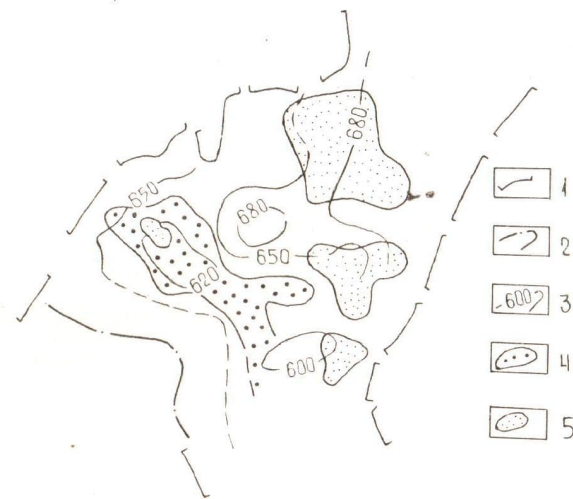
Рис. 2. Схема изменения плотности нефтей и потенциальных дебитов пласта ЮК 10 : 1, 2 — то же, что и на рис. 1; 3 — изолинии плотности нефтей, кг/т; 4 — зона высокодебитных скважин; 5 — зона низкодебитных скважин.
