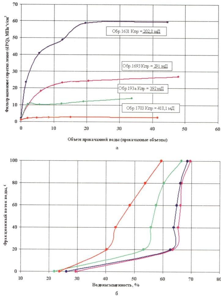
Рис. 2. Зависимости фильтрационного сопротивления от объема прокачанной воды (а) и фракционного потока воды от текущей водонасыщенности (б), полученные для моделей пластов БВ<sub>8</sub> и БВ<sub>9</sub> Аганского и Западно-Аганского месторождений
