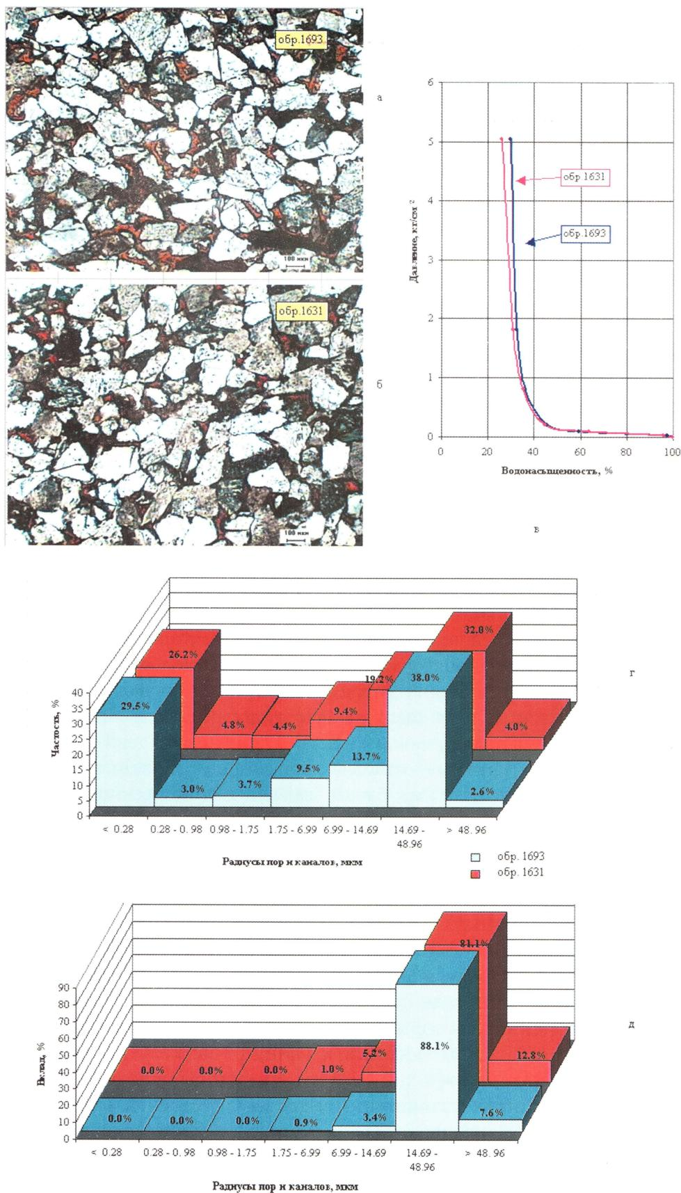
Рис. 3. Фотографии прокрашенных смолой петрографических шлифов (а, б), капиллярных кривых (в), распределение пор и соединяющих их каналов по размерам (г) и вклад пор и каналов в фильтрацию (д).
