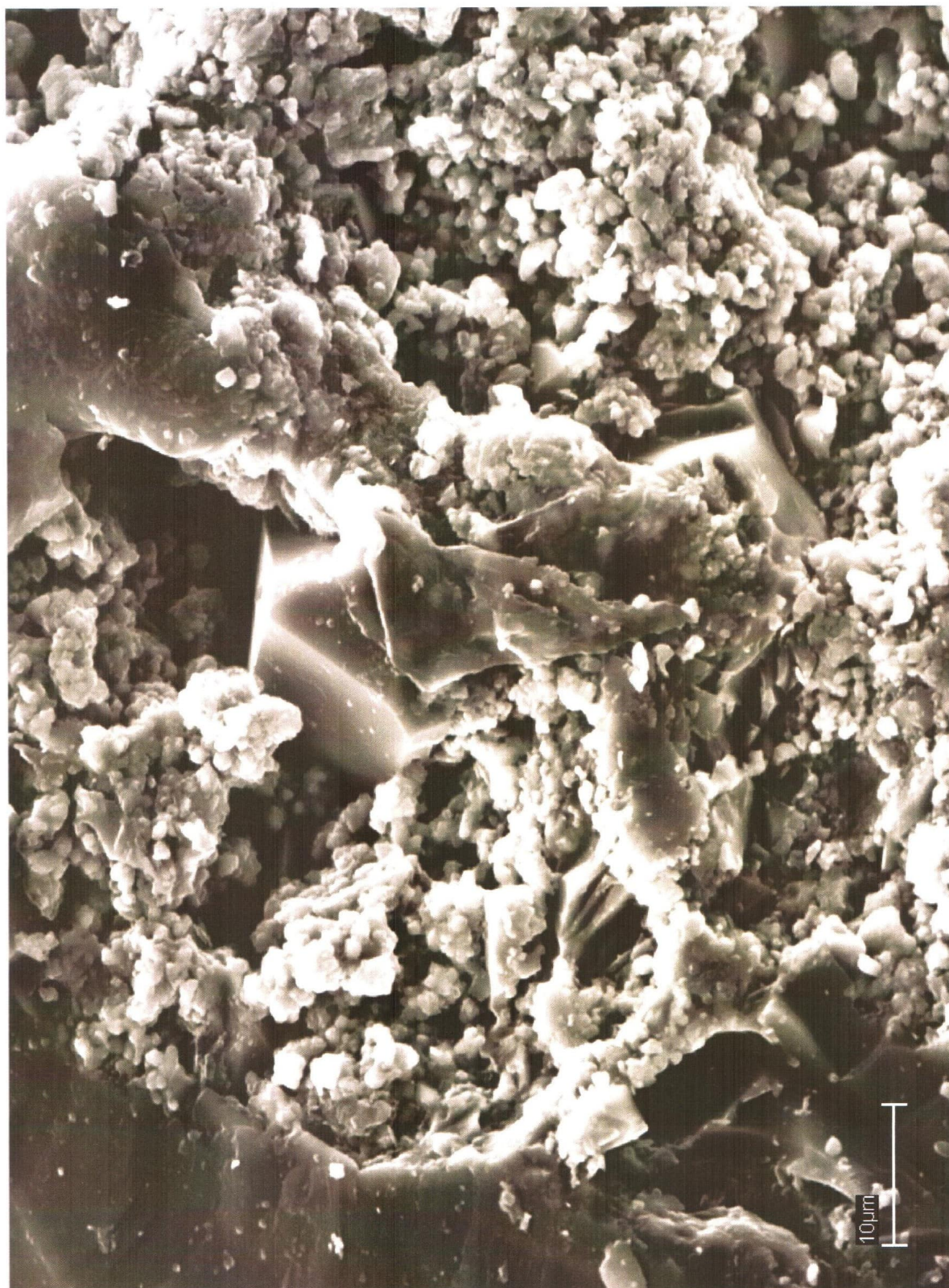
Рис. 13. Микрзернистые агрегаты рутила в образцах, отобранных из пластов ЮК 9 (а) и ЮК 10 (б)
