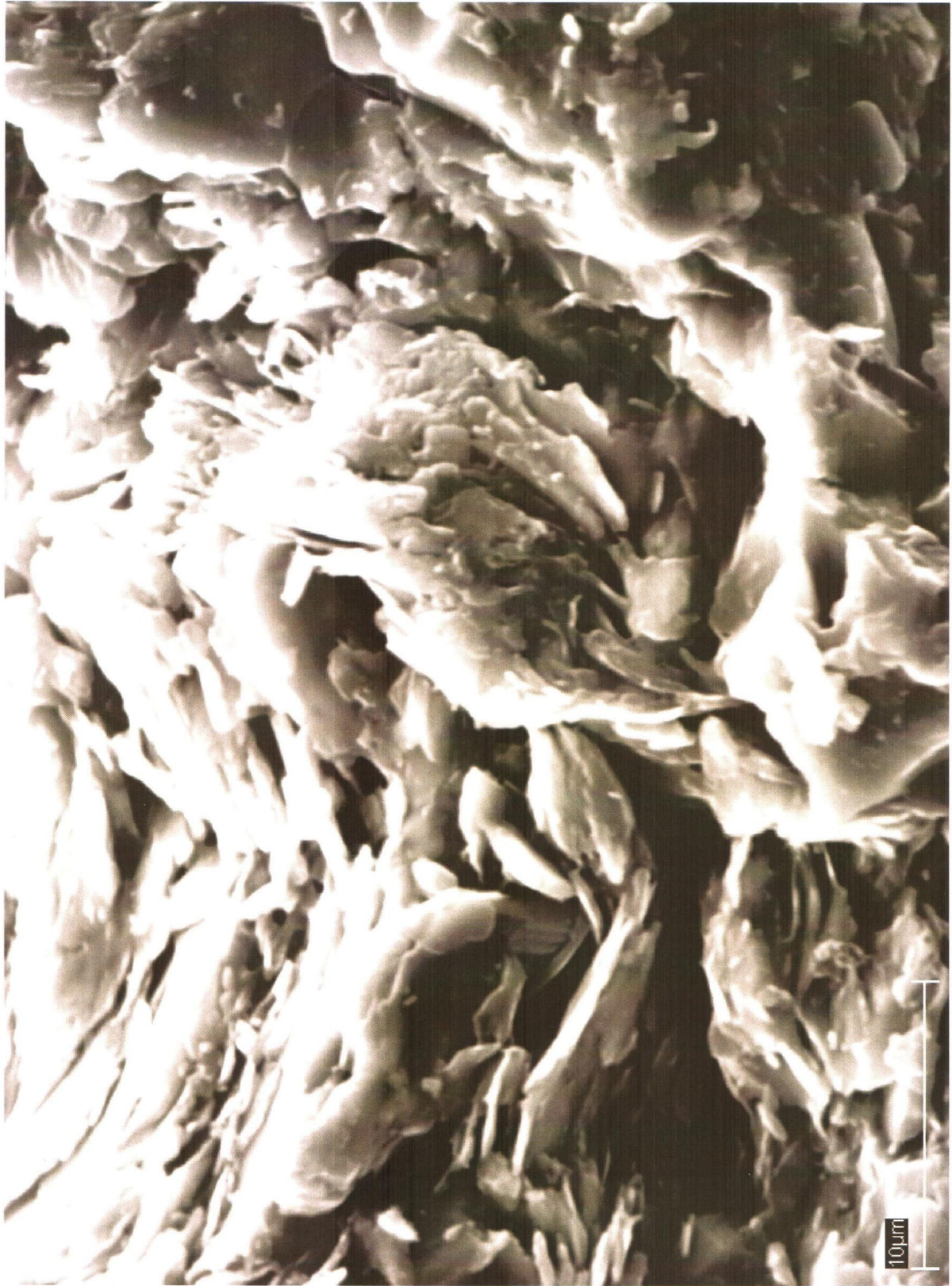
Рис. 7. Псевдоморфозы каолинита по терригенному хлориту в образцах, отобранных из пластов ЮК 9 (а) и ЮК 10 (б)
