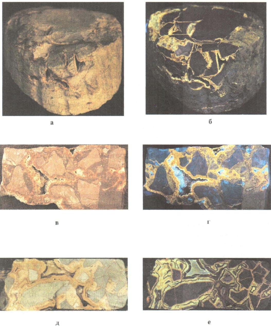
**Рис. 2. Фотографии образцов трещиновато-кавернозных известняков с захваченной в процессе роста эпигенетического (пленоично-порового) кальцита микрокапельной нефтью, отобранных из отложений абалакской свиты и её литостратиграфических аналогов, снятые в белом (а, в, д) и ультрафиолетовом (б, г, е) свете: а, б - Усть-Балыкское; б, г - Салымское; д, е - Сыморяихское месторождения**
